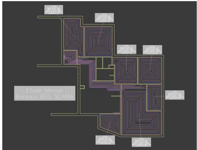
Le tracé complet d'un niveau avec raccordement des boucles aux collecteurs
